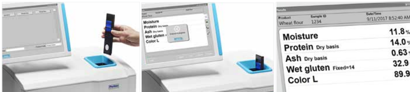
Umieszczanie kuwety w szczelinie pomiarowej
